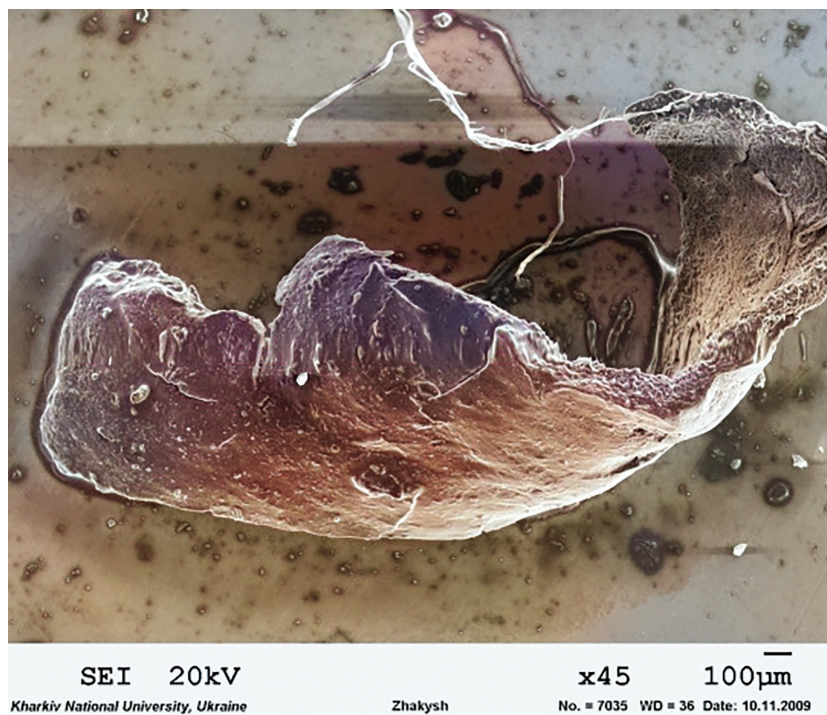
Рис. 3. Растровая электронная микроскопия золотной нити покрова: конструктивные особенности. 2009 год.
